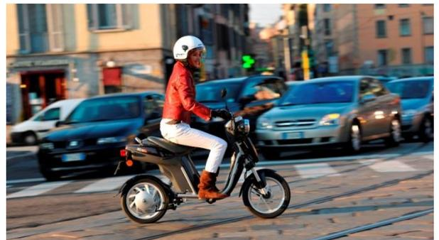
Unter dem Namen E-Florett sind zwei 45 km/h-Elektro-Scooter der Marke Kreidler erhältlich. Die Version 1.0 besitzt einen 3000 Watt starken Elektromotor und einen herausnehmbaren Blei-Silicon-Akkupack. Bei der Version 3.0 ist ein 4000 Watt starker Motor verbaut. Auch hier ist das Akkupack austauschbar, allerdings handelt es sich um Lithium-Eisenphosphat-Akkus. Darüber hinaus bietet die E-Florett 3.0 weitere Features wie einen Leistungswahlschalter und eine Vierkolben-Radialbremsanlage vorn.
